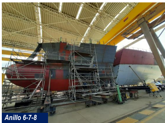
Ilustración 28. Avance proceso construcción Patrullera Oceánica Colombiana (POC)
